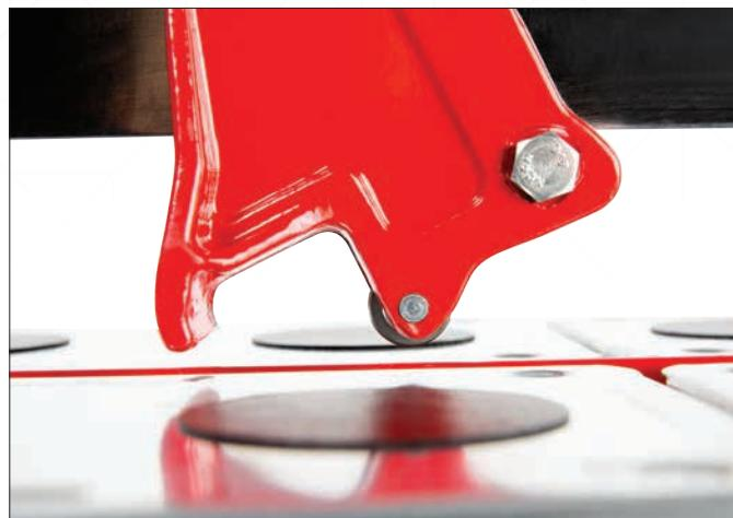
Резак используется с алмазом Ø 18 мм.
