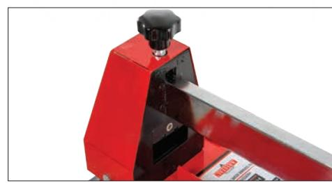
Лазерный модуль точно показывает линию разреза керамики.
