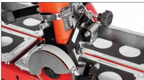
Глубину турбопилы можно быстро отрегулировать, повернув специальный винт.
