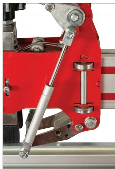
Система газового амортизатора для постоянного давления.
