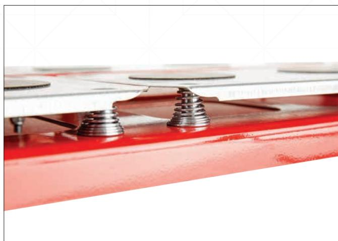
Пружинные пластины, привинченные к стальному основанию, обеспечивают более комфортный и качественный перелом керамики.
