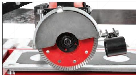
В двигателе используется турбопила Ø 115 мм.
