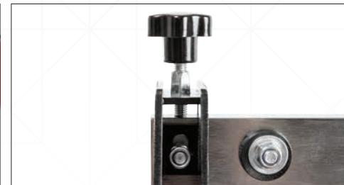
Высота рельсы регулируется специальными вентилями, в зависимости от толщины керамики, которую необходимо разрезать.
