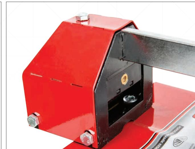
Лазерный модуль показывает точную линию разреза керамики.
