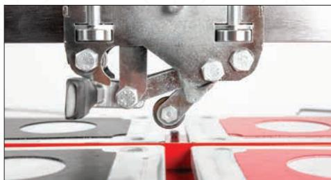
Резак с шарикоподшипником используется с алмазом Ø 22 мм.
