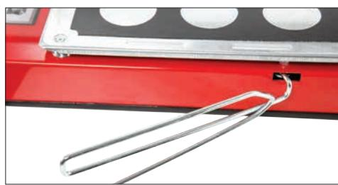
Пружинные пластины, привинченные к стальному основанию, обеспечивают более комфортный перелом керамики.
