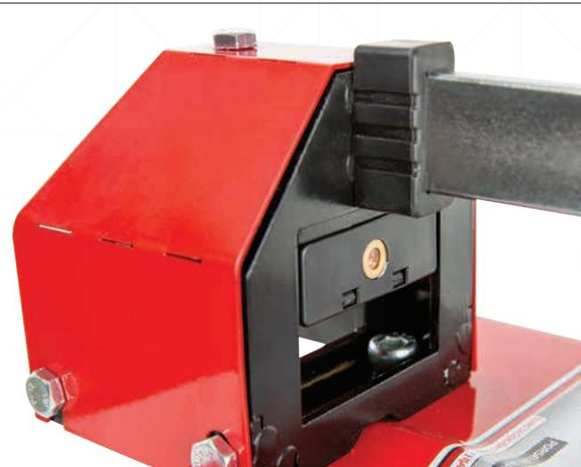
Лазерный модуль точно показывает линию разреза керамики.
